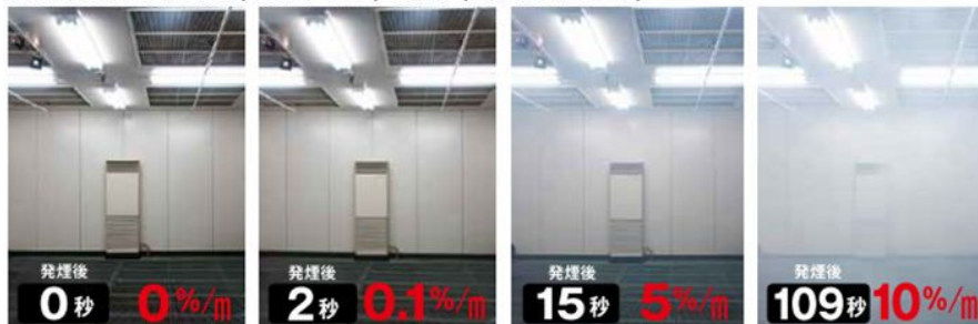
発煙片を用いた煙濃度 (減光率 %/m) の推移 (当社実験室にて)
