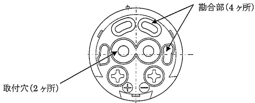
上図、取付穴に2ヶ所にM3長さ15mm以上のネジを使用して取り付けて下さい。
